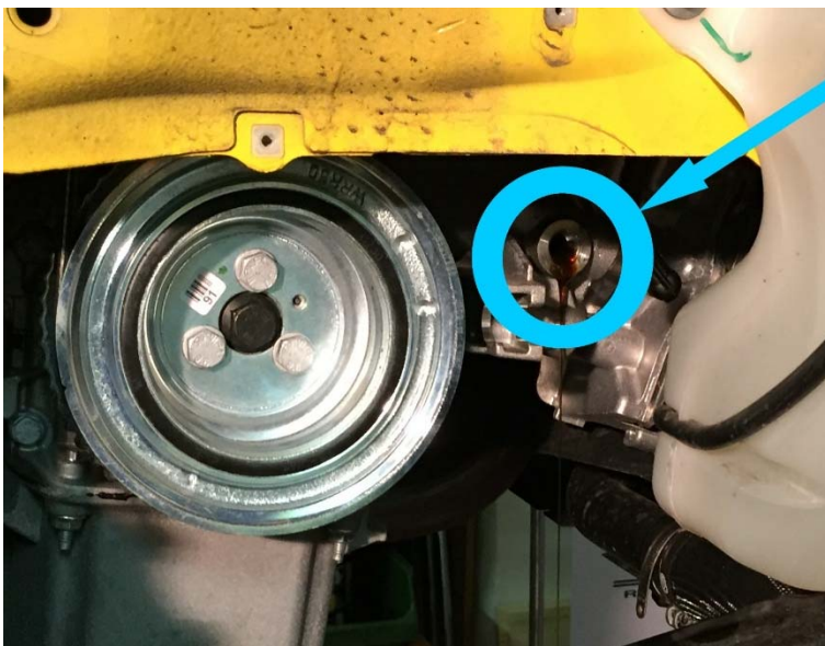
Foto 18) Rimuovere il bulbo pressione olio del veicolo (foto 19)
