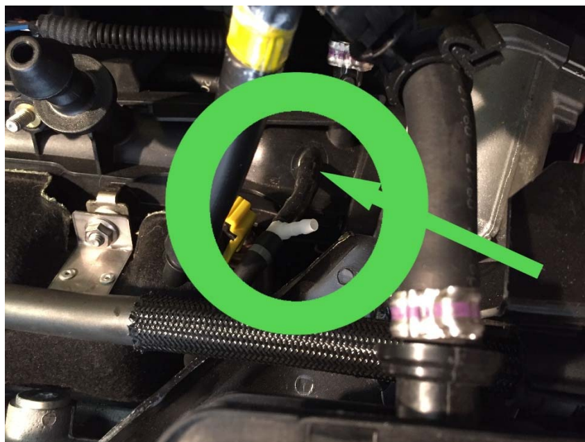
Foto 35) Inserire il nuovo tubo nel collettore aspirazione.
